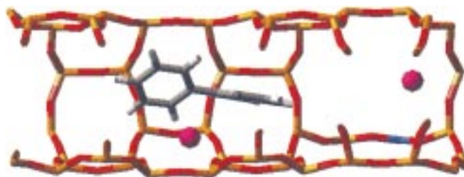
Abbildung 1. Senkrecht zur b -Achse gezeigte Ansicht von Biphenyl, das in den geraden Kanälen von \text{Na}_4\text{Si}_{92}\text{Al}_4\text{O}_{192} -Zeolith eingeschlossen ist ( \text{BP}, \text{S}_0 ). Die gelben (Si), blauen (Al) und roten (O) Stäbchen stellen das ZSM-5-Gerüst dar, die violetten Kugeln sind die nicht im Gerüst enthaltenen \text{Na}^+ -Ionen und die schattierten und weißen Zylinder die C- bzw. H-Atome von BP.
